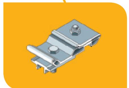
Die Entscheidung für eine **Montageklemme** ist eine Entscheidung für die einfache Montage. Bei der Montage der Profile sind nämlich keine Schrauben und Muttern mehr erforderlich. Die Unterseite des Aluminiumprofils wird in die Klemme geklickt und die vormontierte Schraube kann direkt angezogen werden.
